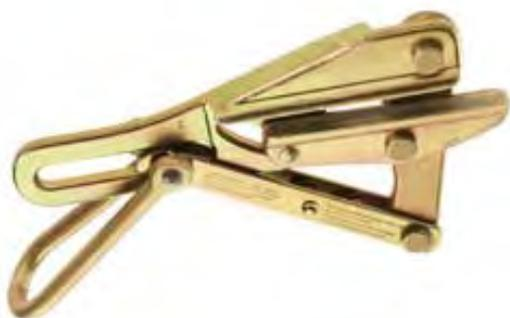
El contorno interior y liso de las quijadas de esta serie de mordazas es ideal para los cables desnudos, tipo ACSR, Aluminio y Cobre trenzado. Las Quijadas lisas tiran con un máximo de contacto, disminuyendo así la probabilidad de daño a los conductores
