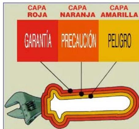
Cada llave aislada IREGA es sometida a un test de alto voltaje de acuerdo con la norma EN-60900, equivalente a IEC-900, es decir, 10.000 V durante 10 segundos y sólo se aceptan aquellas que soportan satisfactoriamente el ensayo. **Aviso importante:** Las llaves ajustables con aislamiento no se pueden homologar, dado que la parte que se manipula, la moleta, no puede ser aislada. Por ello, no se puede garantizar la completa seguridad del usuario.
