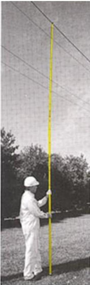
**Medición de alturas verticales con seguridad dieléctrica
