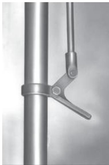
El gatillo ubicado en el extremo de la varilla de operación controla un rodillo que abre y cierra las mandíbulas del amperímetro.
