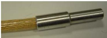
Grosor de pértiga sin extender = 38mm ( al extremo de conexión )
