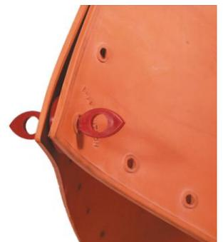
**Botón Magnético para Mantas:** está diseñado para ser insertado en el ojal de las mantas aislantes cuando se deben cubrir partes energizadas en áreas difíciles de proteger, como equipos de pedestal (pad mounts), cubículos, tableros y subestaciones. Tiene cuatro imanes flotantes montados entre placas de acero niqueladas. Puede ser montado usando guantes de caucho, o con una pértiga de gancho retráctil.
