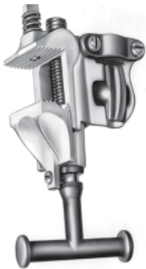
G3363-2 Cuerpo de bronce, Mordazas dentadas, Manija de bronce en T con rosca fina, Terminal de bronce tipo a presión
