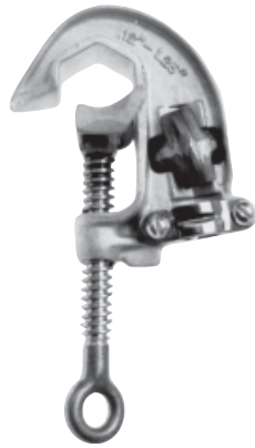
C600-2275 Cuerpo de aluminio, Mordazas lisas, Perno de bronce con ojal con rosca Acme, Terminal de bronce a presión
