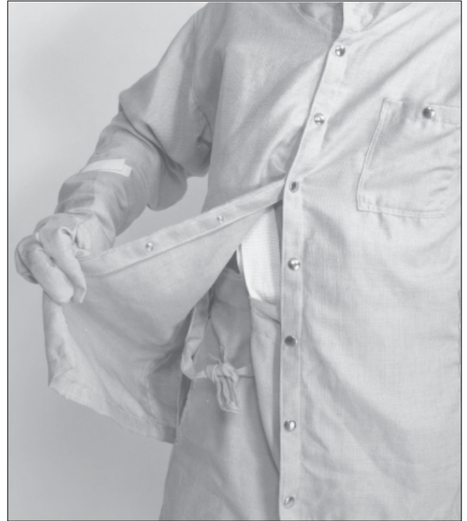
Vista interior de la chaqueta mostrando las cintas equipotenciales de la chaqueta y del pantalón unidas. Esto evita la separación eléctrica entre la chaqueta y el pantalón.
