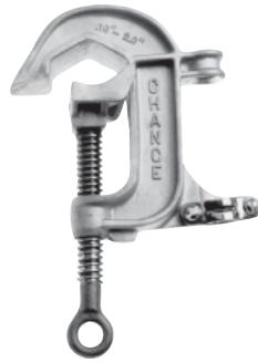
C600-2255 Cuerpo de aluminio, Mordazas lisas, Perno de bronce con ojal con rosca Acme rosca para terminal 5/8" 11 UNC
