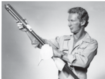
Limpieza de una pértiga con el Limpiador Moisture Eater II de Chance
