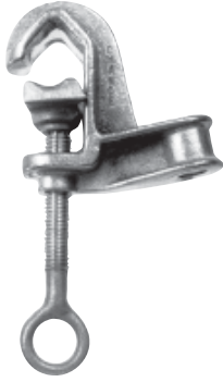
T600-0465 Cuerpo de bronce, Mordazas lisas, Perno de bronce con ojal con rosca fina, rosca para terminal 5/8" 11 UNC o T600-0466, Terminal pasante, sin rosca
