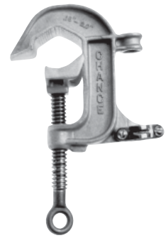
C600-2256 Cuerpo de aluminio, Mordazas dentadas, Perno de bronce con ojal con rosca Acme rosca para terminal 5/8" 11 UNC
