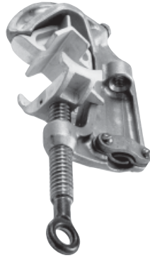
C600-1733 Cuerpo de aluminio, Mordazas lisas, Perno de bronce con ojal con rosca Acme, rosca para terminal 5/8" 11 UNC
