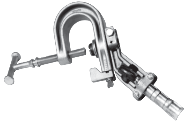
C600-0085 Cuerpo de aluminio y retén, Placa de contacto autolimpiante de bronce, Manija de bronce en T con rosca fina, Terminal de bronce tipo a presión
