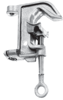
C600-1743 Cuerpo de aluminio, Mordazas lisas, Perno de bronce con ojal con rosca fina, rosca para terminal 5/8" 11 UNC
