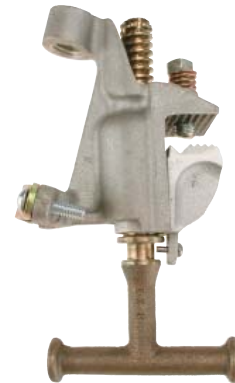
C600-1735 Cuerpo de aluminio, Mordazas dentadas, Perno de bronce con ojal con rosca fina, rosca para terminal 1/8" 11 UNC
