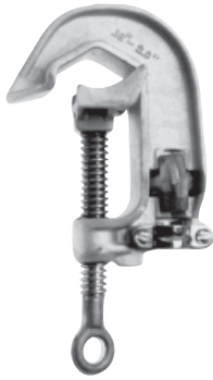
C600-2281 Cuerpo de aluminio, Mordazas lisas, Perno de bronce con ojal con rosca Acme Terminal de bronce tipo a presión
