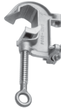
T600-2708 Cuerpo de aluminio, Mordazas dentadas, Perno de bronce con ojal con rosca Acme, rosca para terminal 5/8" 11 UNC
