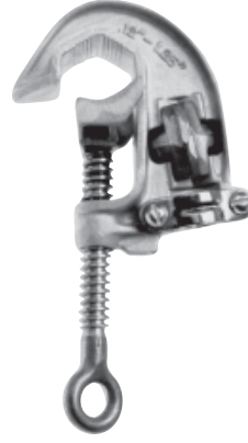
C600-2276 Cuerpo de aluminio, Mordazas dentadas, Perno de bronce con ojal con rosca Acme, Terminal de bronce a presión
