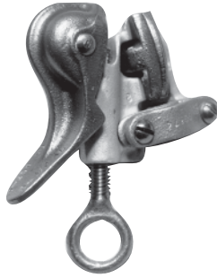
G1810-2 Cuerpo de aluminio, Mordaza superior de bronce, Mordazas lisas, Perno de bronce con ojal con rosca fina, Terminal de bronce tipo a presión
