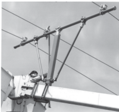
Para aplicaciones trifásicas, el brazo auxiliar puede girar para alinear los soportes de conductor con los conductores y luego fijarlos en esa posición.
