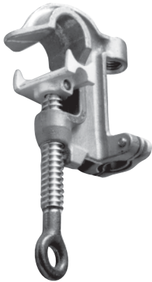
C600-1754 Cuerpo de aluminio, Mordazas lisas, Perno de bronce con ojal con rosca Acme, rosca para terminal 5/8" 11 UNC
