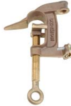
C600-2271 Cuerpo de bronce, Mordazas lisas, Perno de bronce con ojal con rosca fina, rosca para terminal 5/8" 11 UNC
