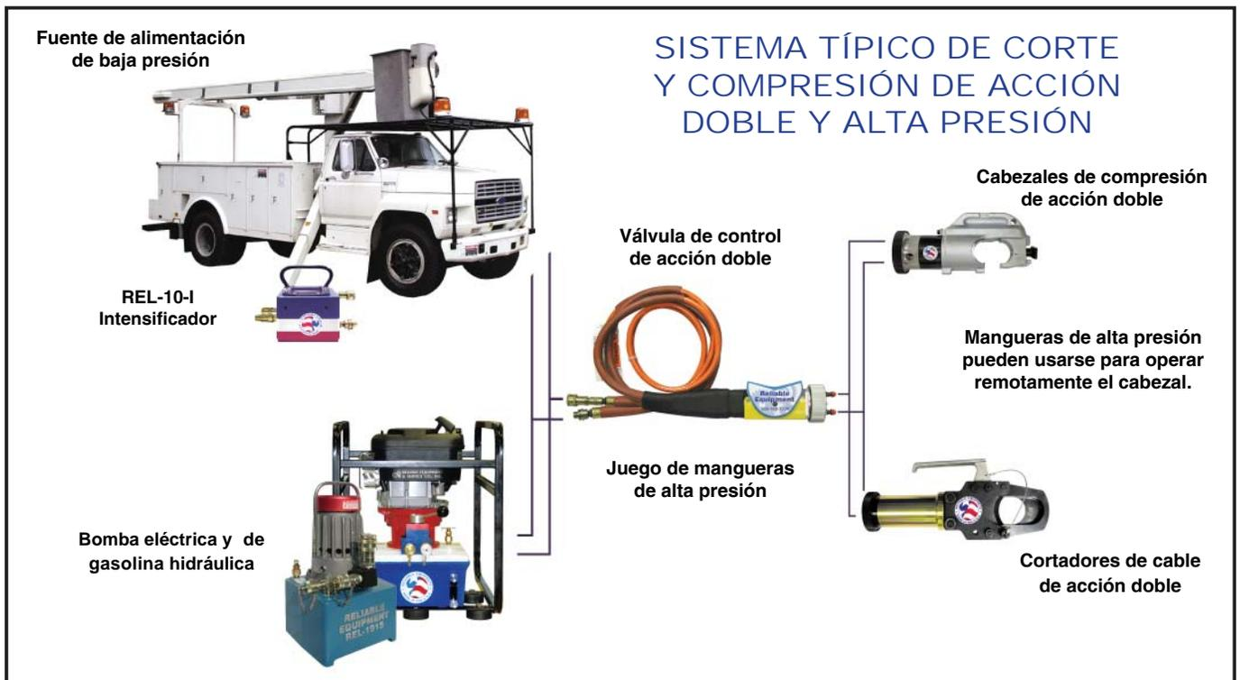
**Intensificador:** Se conecta a fuentes de baja presión de camiones grúa (o unidades de poder portátiles) para producir los 10,000PSI (700bar) necesarios para el funcionamiento de herramientas de alta presión.
